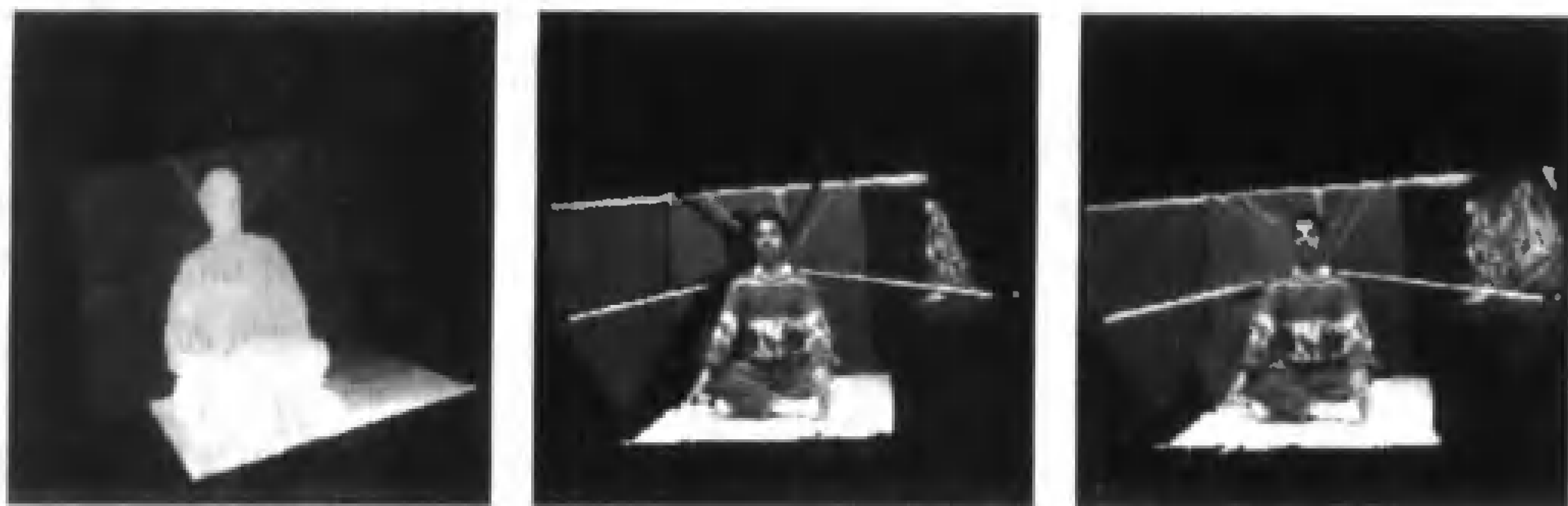
图 26.6 多摄像机立体视觉。从左到右:与一组摄像机关联的深度图;从不同视点观察到的相应网格的纹理映射图(注意深度图里暗区域表示深度不连续);从两个邻近摄像机构造的纹理映射图(注意缝隙已经被填补了)
