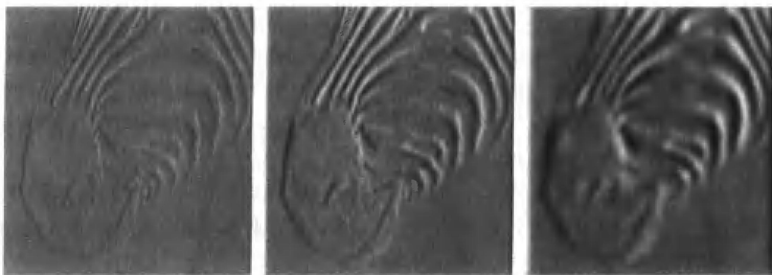
图 8.5 在高斯导数滤波器中,高斯函数的尺度(也就是 \sigma )对结果有显著的影响。三幅图显示了一幅斑马头的图像在 x 轴方向的导数,分别使用了1个像素、3个像素、7个像素的 \sigma 高斯导数滤波器(从左向右)。注意在一个较细尺度下图像是如何显示出毛发的,动物的毛发在中等尺度下未能显现出来,同时斑马口上方的细密斑纹在较粗尺度下未能显现出来
