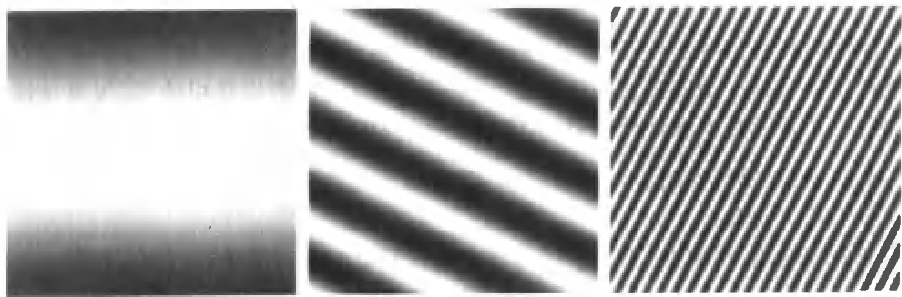
图 7.5 傅里叶变换基元素的实数部分表示为灰度图像。最亮的点数值为 1,最暗的点数值为 0。域的范围是 [-1,1] \times [-1,1] ,以图像中心为原点。左图中, (u,v) = (0,0.4) ;中间的图中, (u,v) = (1,2) ;右图中, (u,v) = (10,-5) 。这些是文中描述的不同频率和方向的正弦函数 傅里叶逆变换 把一个信号从它的傅里叶变换中恢复过来是很有用的。这是对基的另一种变化:
