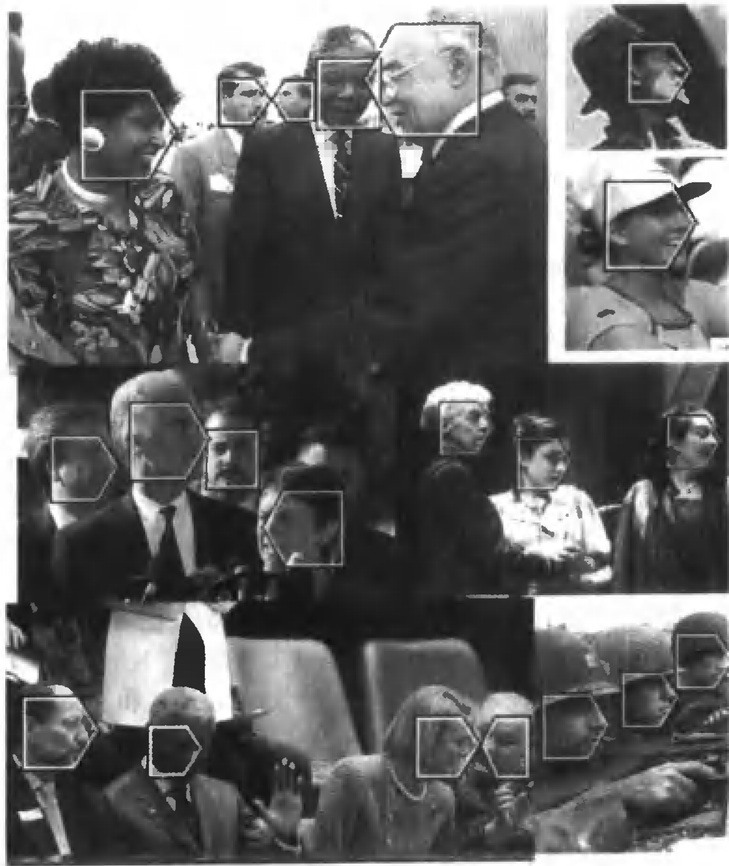
图 22.5 上图给出了 22.2.2 节介绍的人脸检测方法的一些检测结果。不同尺度的图像窗口根据从训练样本中学习出的人脸似然率模型被划分成为正面人脸、侧面人脸及非人脸。图像窗口中的一些子区域被划分成为一些类别,这些类别是从训练样本中学习得到的。人脸似然率模型认为,一个图像窗口中处于不同位置的子区域属于哪个类别是相互独立的,模型最终给出了图像窗口对各个类别的后验概率,我们可以根据这个后验概率判断图像窗口属于哪个类别
