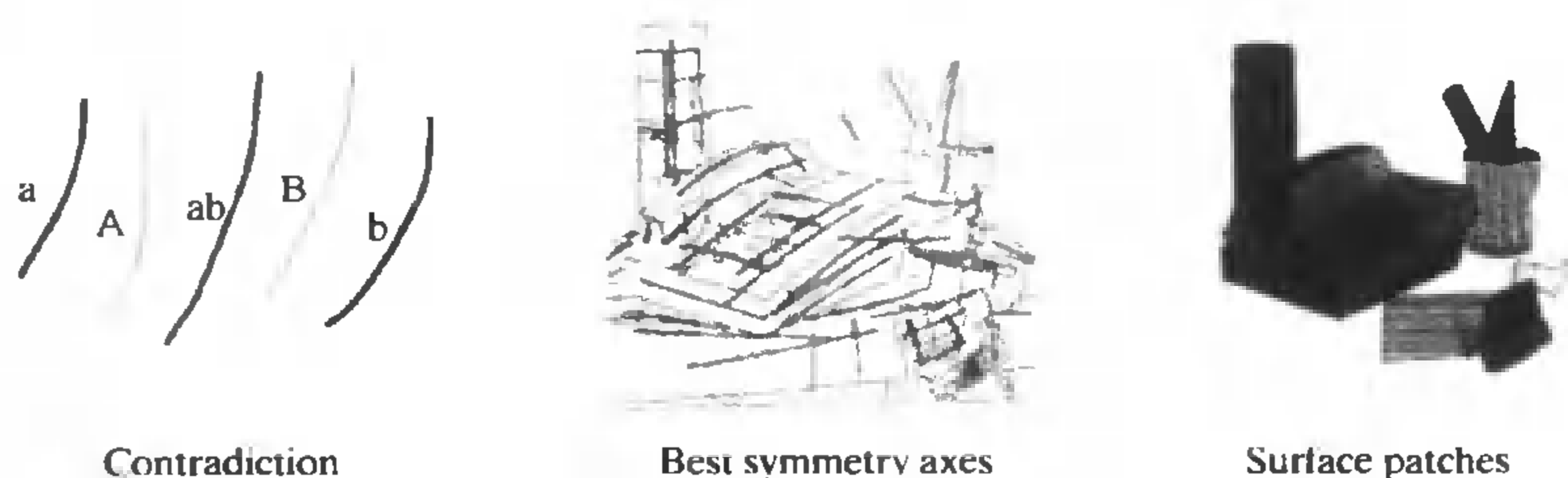
图 24.17 左图：一个一致性准则的说明；两根轴如图中 A 与 B 不能共享曲线中标为 ab 的同一片断（否则的话这个视点会是一种巧合）。必须从众多轴线中鉴别出最好的一组轴线，利用连续性等指标进行评价并考虑违反一致性准则所起的负面作用。这是一个求最佳的问题，可以用各种求优化解算法（Mohan 与 Nevatia 使用松弛法）。中图：展示了一组获得极值的轴线。可以将它们与相应的边界联系起来，得到一组表面假设，经过与遮挡关系推理有关的进一步处理后得到的一组假设表面展示在右图上
